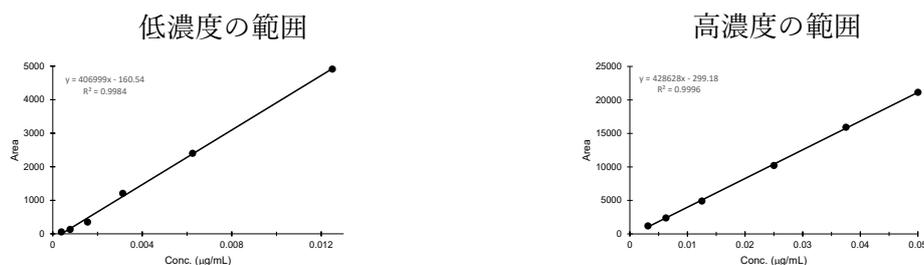
図 5 SPM の検量線 (定量イオン) の例
