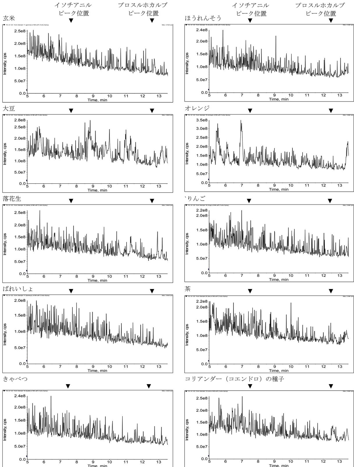
図 38 ブランク試料の全イオン電流クロマトグラム(ESI+)
