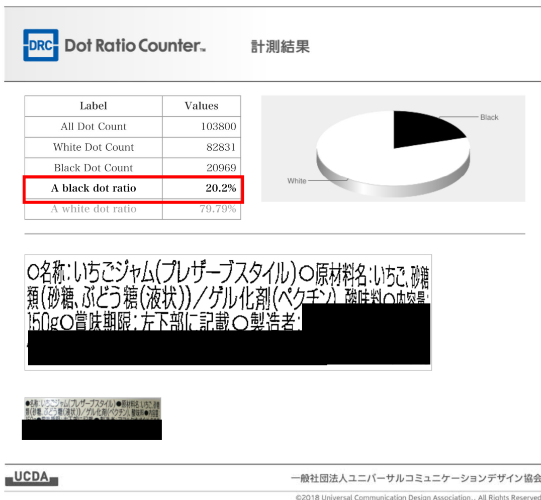
図 2-13：ドット・レシオ・カウンターによる一括表示の測定画面 この場合、情報量は赤枠部分の「20.2%」である。
