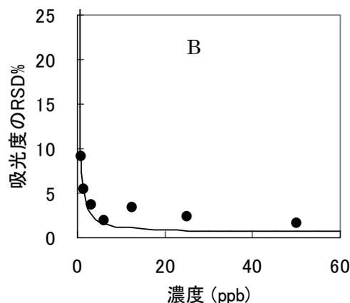
図A-1 特定原材料検出キットの精度プロファイル
