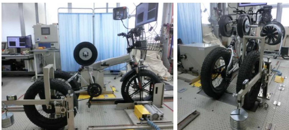
写真2. アシスト比率測定の様子（一例）
