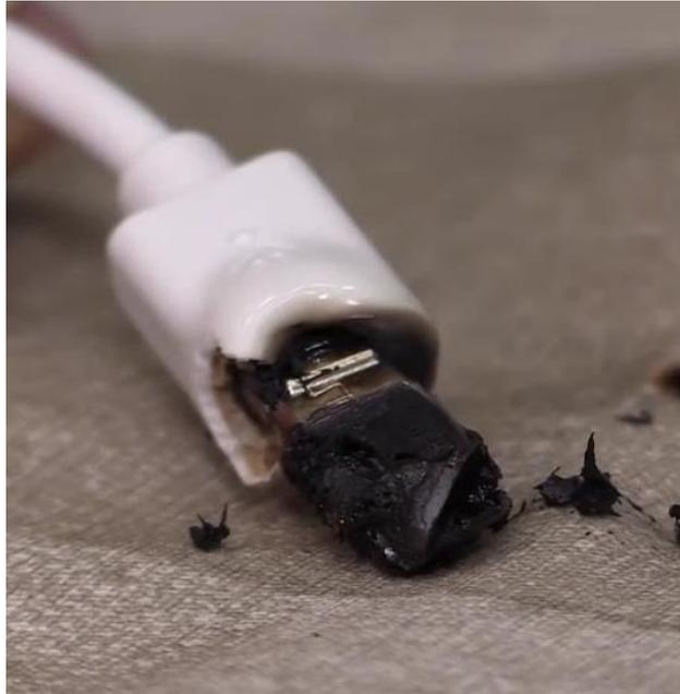
図5 焼損した充電ケーブルのコンネクタのイメージ（提供：NITE）
