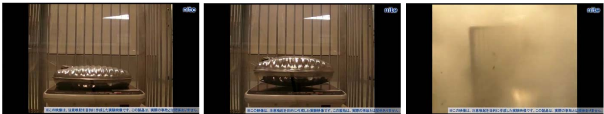
写真2 NITEによるお湯を入れるタイプのゆたんぽの口金（キャップ）をしたまま加熱し、内圧の上昇により破裂した事故の再現映像
