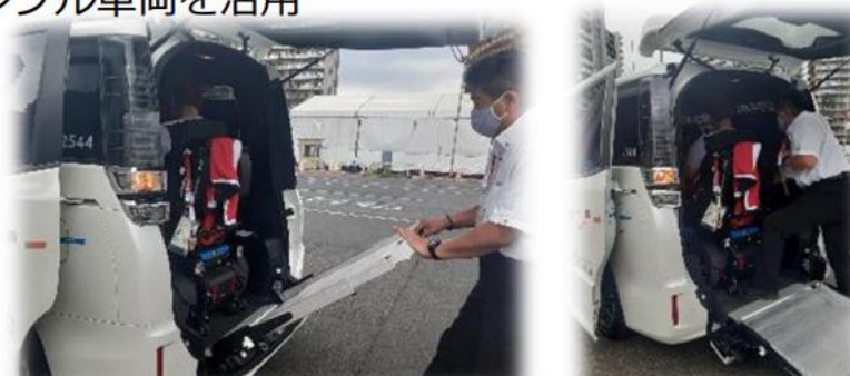
車両に付属するスロープ板をセットし、乗車
