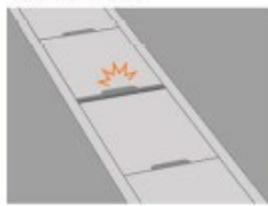
側溝の蓋のすき間
