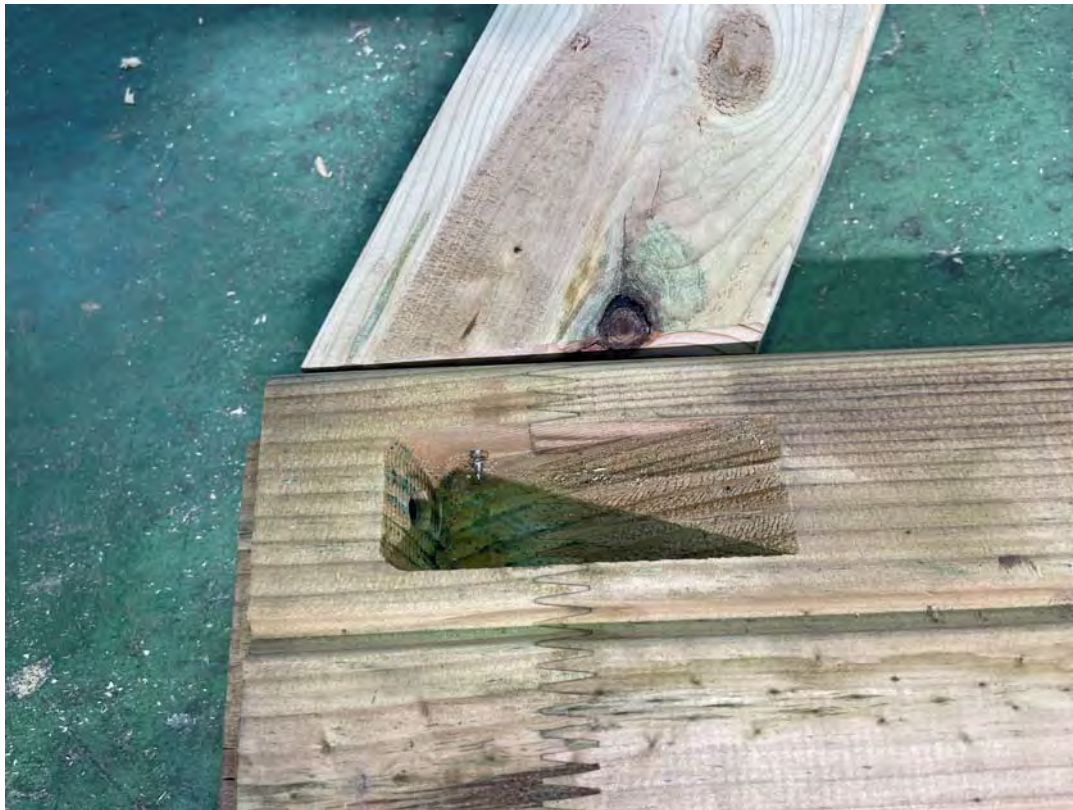
実験後の試験体（引張筋交い接合部）：ビスが筋交いを貫通するケース（左：筋交い 右：梁）
