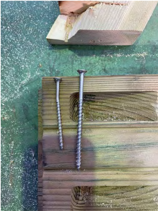
実験後の試験体（圧縮筋交い） 筋交い接合金物状況 ビスが曲げ変形している
