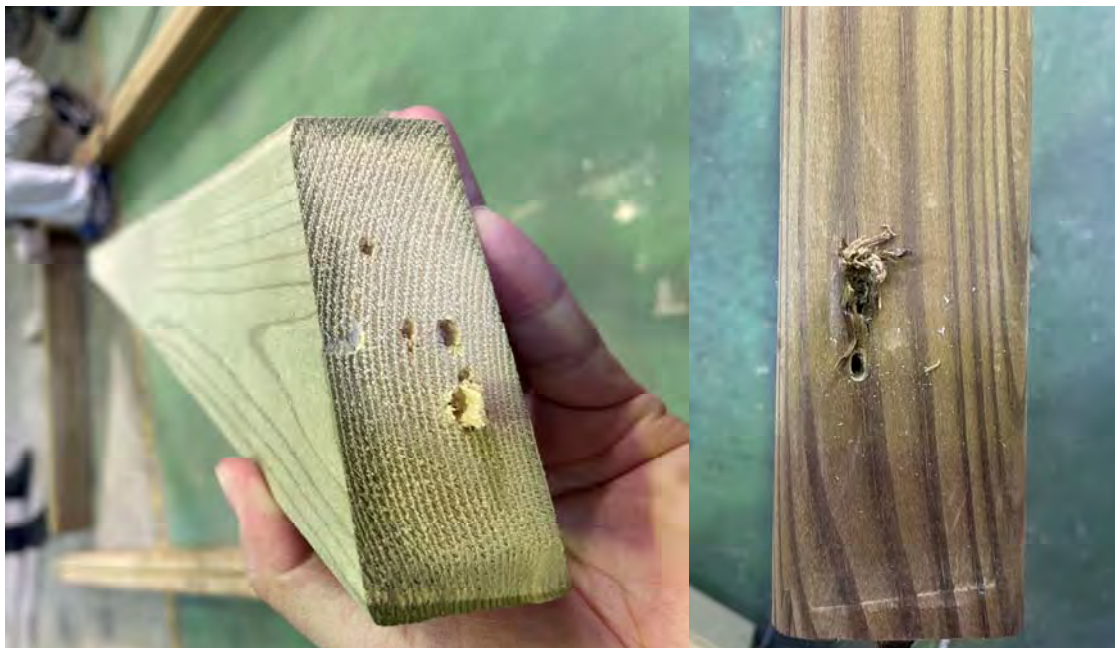
実験後の試験体（引張筋交い接合部）：ビスが筋交いを貫通するケース（左：筋交い 右：梁）
