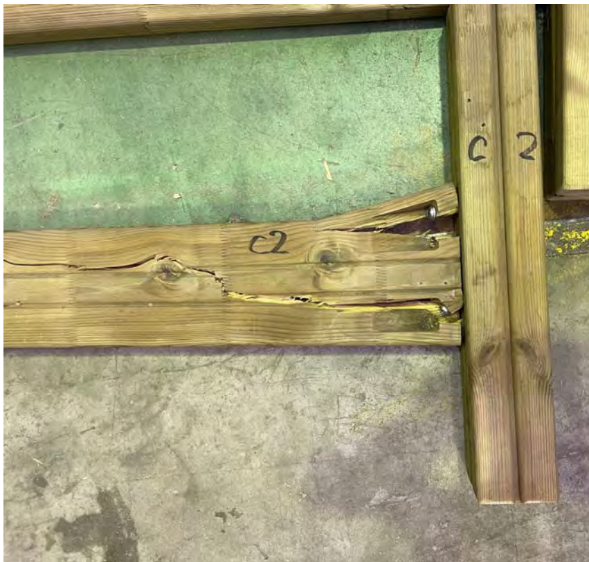
柱一梁接合部 C 実験終了時：接合部の状況 下段のコーチスクリューの曲げ変形が見受けられる
