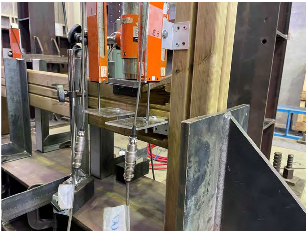
柱一梁接合部 B 実験終了時：梁上部の割裂
