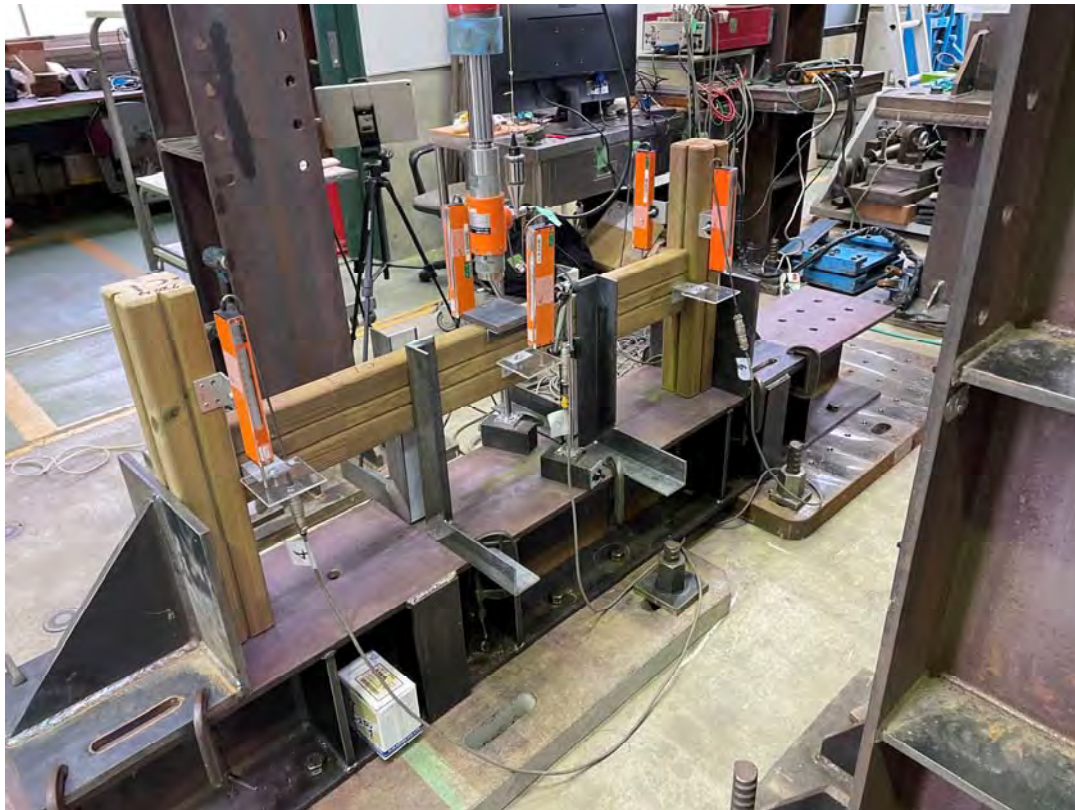
柱一梁接合部 C 実験（中央載荷）
