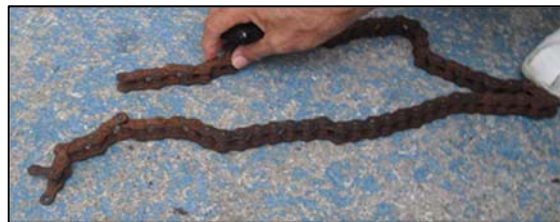
写真1 破断したチェーン
