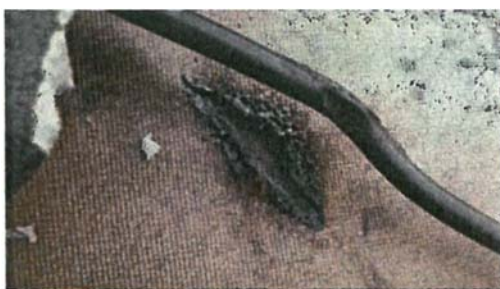
写真A.12 アレイケーブルの挟み込み痕 写真A.13 モジュール固定金具下への ※ただし、傷は外皮にとどまっている。 ケーブルの挟み込み箇所
