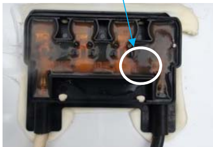
写真 11 バイパス回路の断線箇所 (端子ボックス内部)
