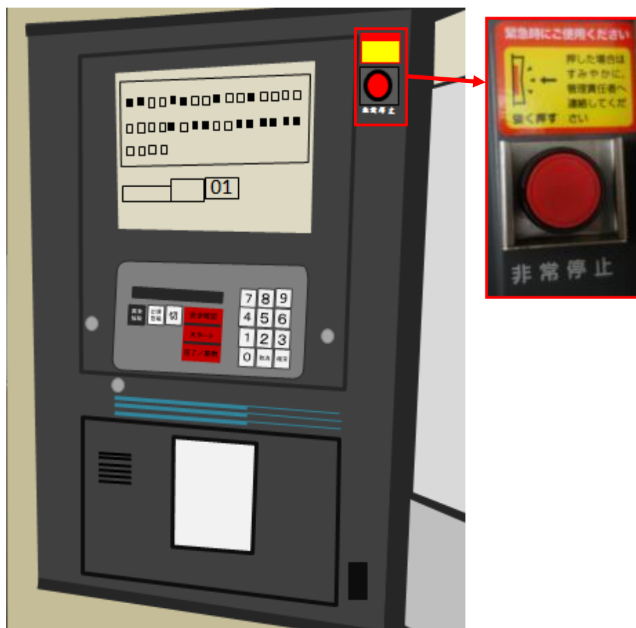
図15 操作盤上の非常停止ボタン
