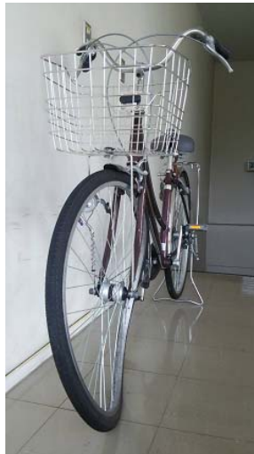
図1 前車輪の変形例
