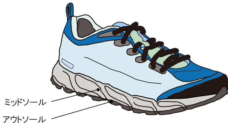
図1 スニーカーの底の構造
