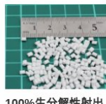
100%生分解性射出成形用ペレット (PBS+PLA) バイオマス由来成分を含有したPLA樹脂ペレット
