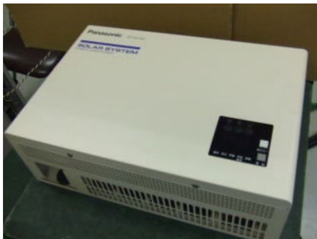
パワーコンディショナ（太陽光発電システム用）（管理番号：A201901229）
