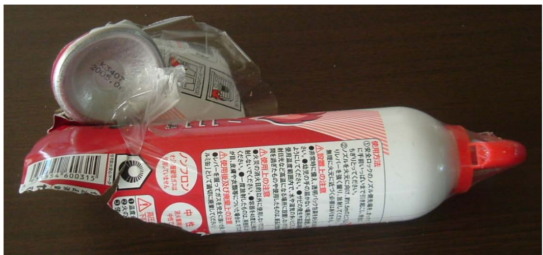
破裂した回収対象製品
