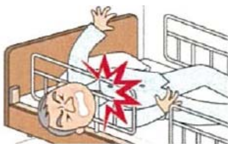
（手すり自体の隙間）
