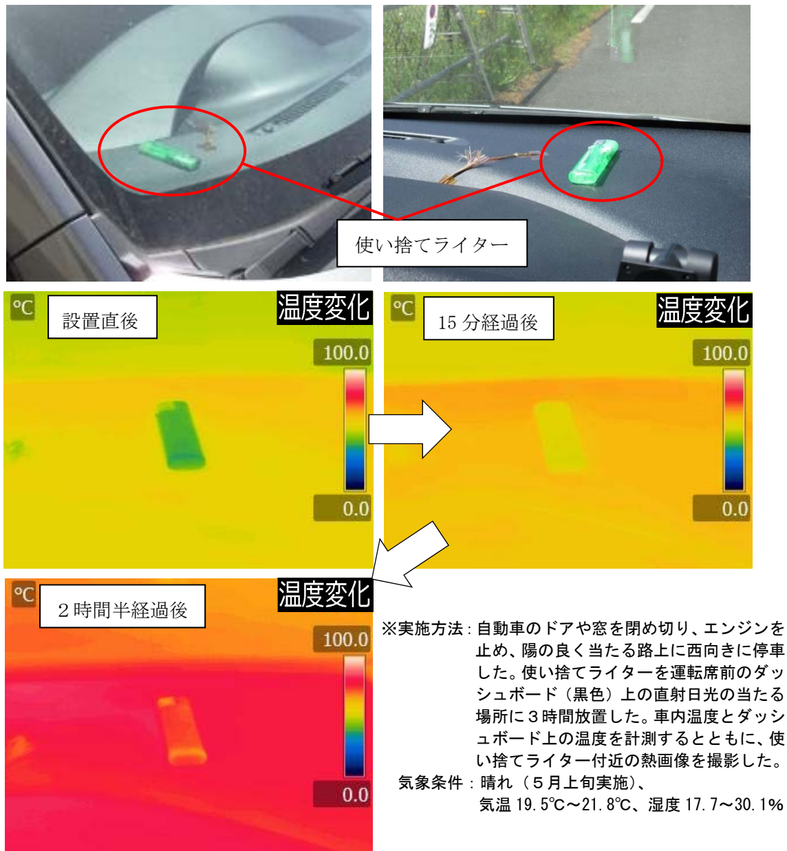
図 4. 車内に放置された使い捨てライターの温度測定
