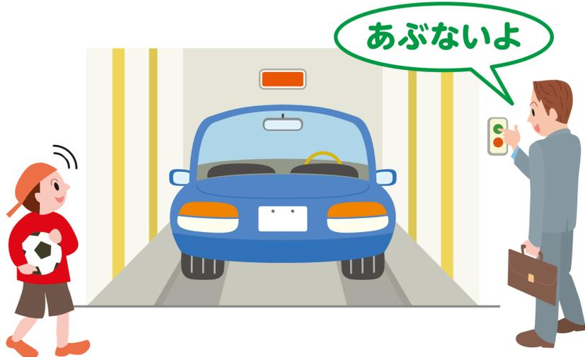
駐車装置の**操作ボタンを器具などで固定し押し続けた状態にすることは絶対に行わない**でください。
