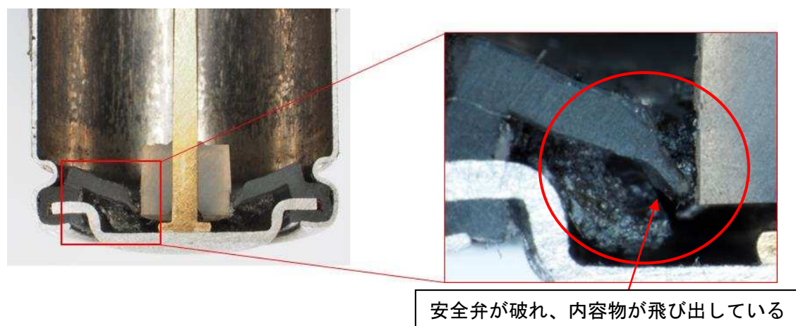
【液漏れした状態のアルカリ乾電池】
