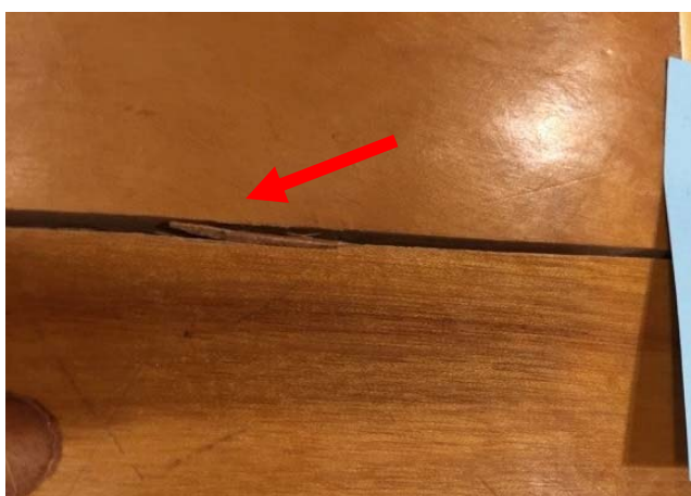
図10 長辺部分に発生した割れ
